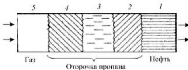
Рис. 5.2. Распределение углеводородов при вытеснении нефти жидким пропаном: 1 – нефть; 2 – зона смеси пропана с пластовой нефтью; 3 – зона чистого пропана; 4 – смесь пропана с сухим газом; 5 – сухой газ
